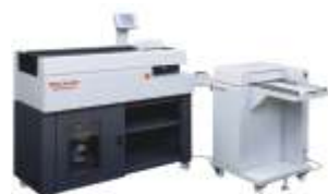
BQ-160+CRB160: Mașină de broșat 1 bac + Mașină de bignut coperti Max. 180 cărți/oră
