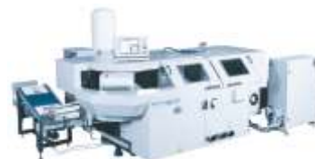
SB-07: Echipament de broșat 7 bacuri. Max.3200 cărți/oră
